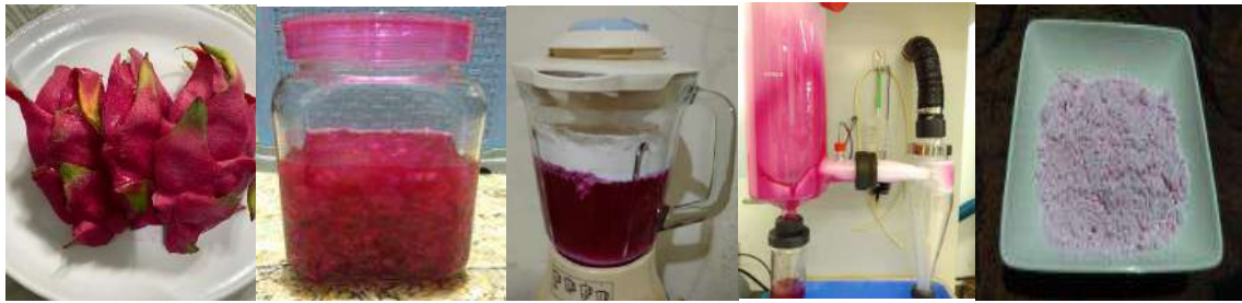
Gambar 43. Proses pembuatan bubuk pewarna kulit buah naga merah dengan teknik spray drying (Sumber: dokumen pribadi)
